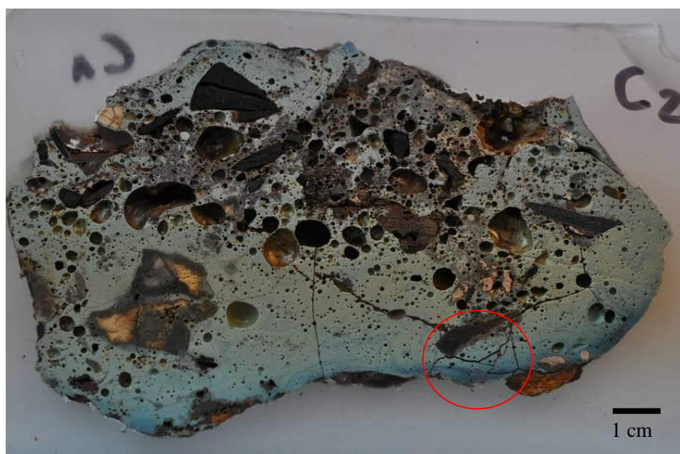
Figure 47 : Photographie d'un tronçon du bloc GL08-11 et localisation d'un échantillon prélevé pour tomographie
