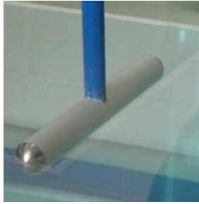
FIGURE 5.2 – Le capteur bi-polaire. Les deux électrodes sont situées aux extrémités et sont de forme hémisphérique. Les deux électrodes ainsi que le tube isolant cylindrique qui les sépare ont un rayon de 1 cm.
