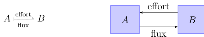
FIGURE 3.2 – Représentation équivalente sous forme de bond graph et de schéma bloc d'un transfert de puissance de A vers B
