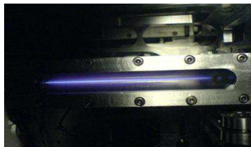
Figure 2.2 : Photographie de la cellule de génération. La ligne de lumière bleutée correspond à l'émission par les atomes d'argon ionisés par le laser générateur. Nous rappelons que dans les conditions optimales de génération l'ionisation doit être faible et de ce fait cette émission plasma doit être peu visible. La longueur de la cellule peut varier de 0 à 15 cm avec des trous d'entrée, de diamètre variable, alignés sur l'axe laser.
