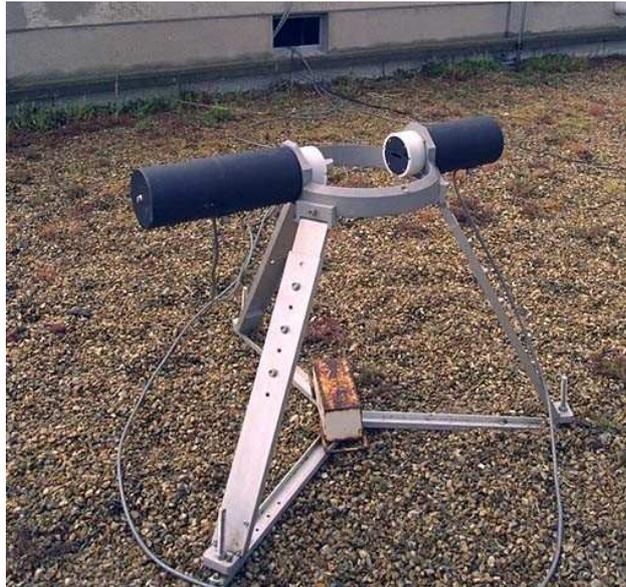
*Figure 5.3 L'instrument DBS (spectropluviomètre bi-faisceaux)*
