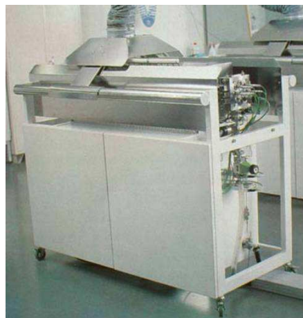
Figure IV.5: Réacteur à flux alterné de type F-120
