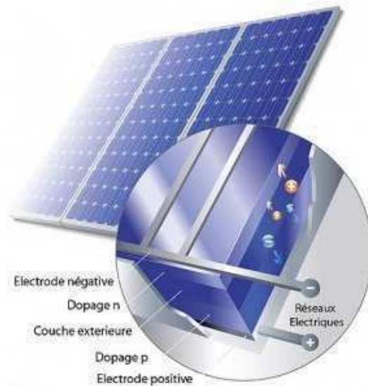
Figure I.1 : Représentation du principe de fonctionnement d'une cellule solaire [2] .
