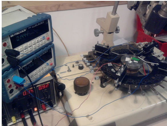
figure 43: Photographie de la manipulation de mesure quatre pointes a) Vue d'ensemble b) Zoom sur l'échantillon
