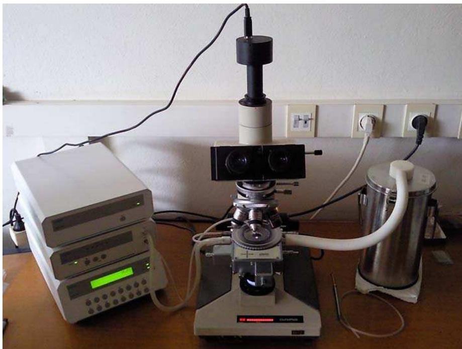
FIG. 4.8 – Installation microthermométrique de l'UMR 5125 (Université Lyon 1). Platine chauffante/réfrigérante Linkam Inc. THM 600 couplée à un microscope optique.
