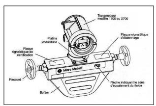
Figure 86 Débitmètre MICRO MOTION (série R)
