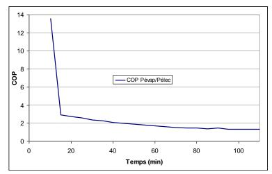
Figure 142 COP Puissance d'évaporation/Puissance électrique compresseur
