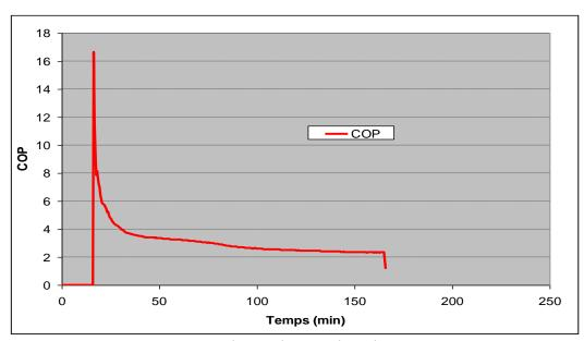
Figure 110 Evolution du COP lors d'un essai typique
