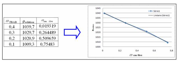
Figure 174 Masse volumique d'une solution de TBAB en fonction de sa fraction massique en eau libre (à proximité de la courbe de saturation)
