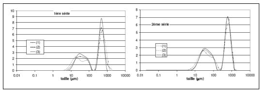
Figure 168 Granulogrammes des hydrates de TBAB (DARBOURET, 2005)
