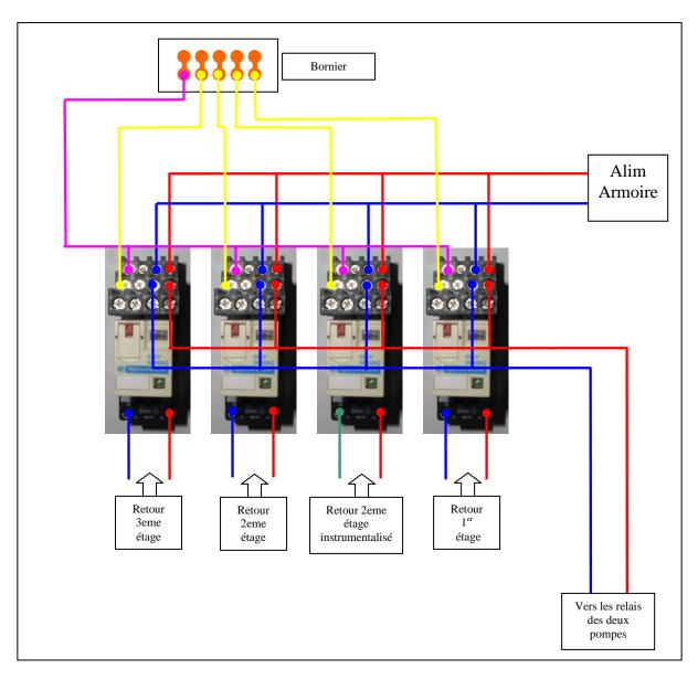
Le bornier est destiné à permettre d'installer des indicateurs visuels à l'extérieur de l'armoire indiquant quels sont les étages où les ventilo-convecteurs sont en marche.
