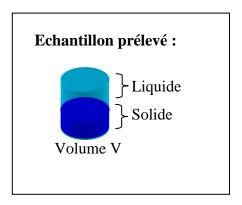
Une mesure de l'indice de réfraction (sur une solution liquide) permet de déterminer la concentration de la solution en TBAB avec la relation suivante :
