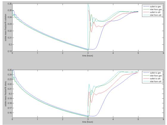
Figure 210 Simulation, caractéristiques du sorbet en fonction du temps pour une solution initialement concentrée à 25% de TBAB
