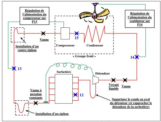
Figure 144 Les modifications prévues sur la boucle primaire
