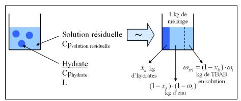
Figure 11 Composition massique d'un kilogramme de sorbet d'hydrates de TBAB
