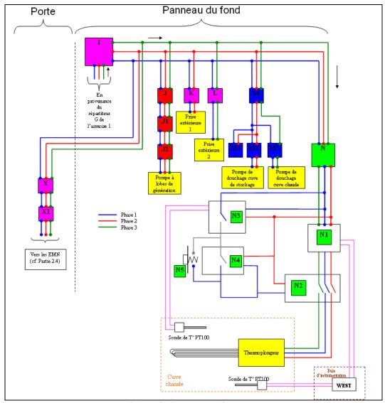
Schéma de l'armoire électrique 2
