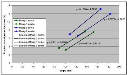
Figure 130 Evolution des fractions massiques d'entrée et de sortie du cristalliseur au cours de deux essais significatifs
