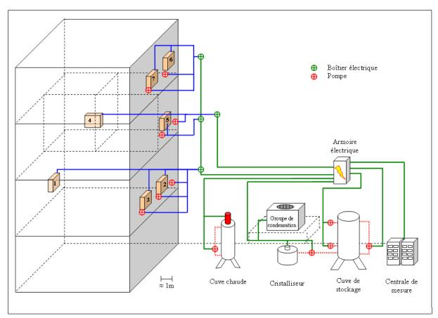
Figure 80 Schéma simplifié des éléments à alimenter électriquement
