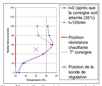
Figure 75 Chauffage de la cuve sans douchage
