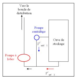
Figure 169 Configuration des pompes de distribution
