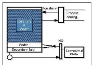
Figure 5 Générateur par contact liquide iStorm
