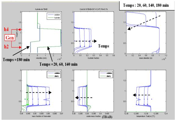
Figure 182 Simulation, caractéristiques du sorbet dans la cuve durant la phase de génération
