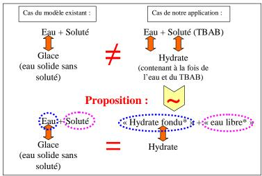
Figure 156 La transposition du modèle-1
