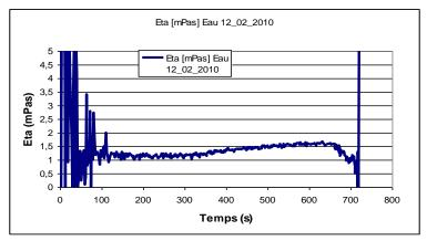
Figure 42 Essais de mesures de viscosité de l'eau
