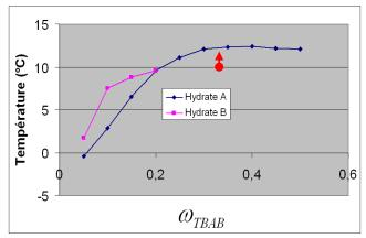
Figure 33 Réchauffement d'un sorbet initialement concentré à 35% de TBAB
