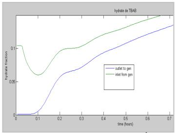
Figure 195 Simulation, fractions d'hydrates (débit de 5 m³/h, début de génération)
