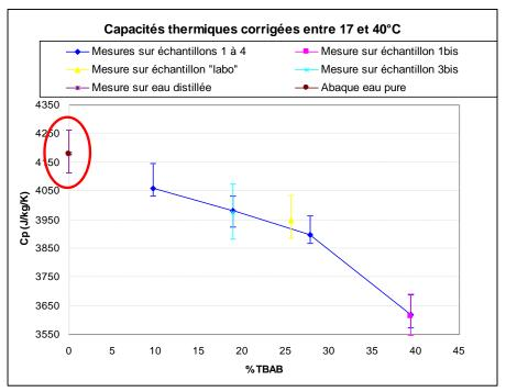
Figure 22 Capacités thermiques des solutions de TBAB
