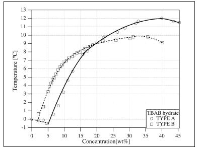
Figure 8 Diagramme d'équilibre des hydrates de TBAB (OYAMA, 2005)
