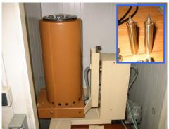
Figure 14 Calorimètre « C80 » et ses capsules
