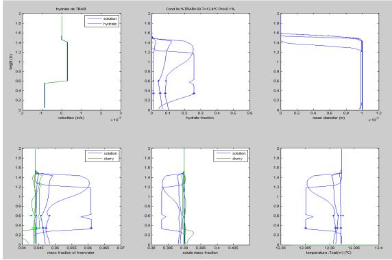
Figure 192 Simulation, caractéristiques du sorbet dans la cuve durant la phase de distribution (génération à 15 m³/h)
