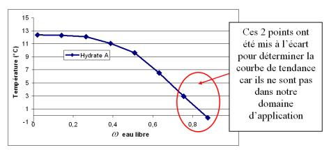
Figure 160 Diagramme d'équilibre transposé des hydrates de TBAB
