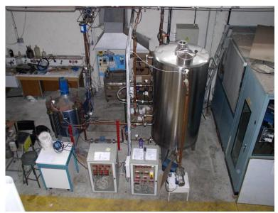
Figure 211 L'installation initiale (générateur, cuve de stockage et centrales d'affichage des capteurs)
