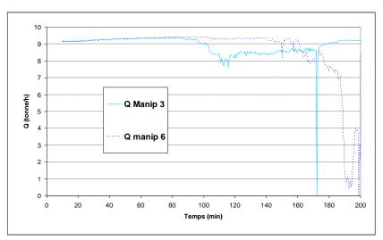
Figure 129 Débit massique du sorbet dans le cristalliseur au cours de 2 essais significatifs
