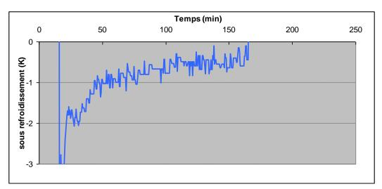
Figure 102 Sous refroidissement en sortie de condenseur
