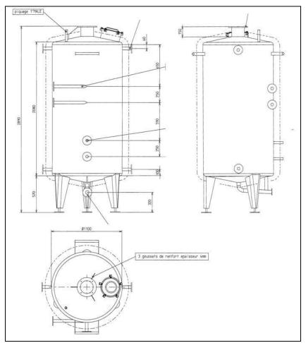
Figure 56 Plan de la cuve de Stockage
