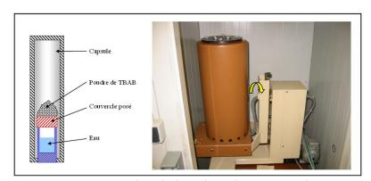
Figure 27 Mesures d'enthalpie de mélange sur calorimètre C80
