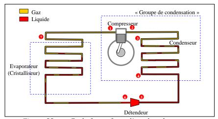
Figure 55 Cycle frigorifique d'une boucle primaire
