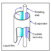
Figure 4 Générateur avec barreaux orbitaux, (GIBERT, 2006)
