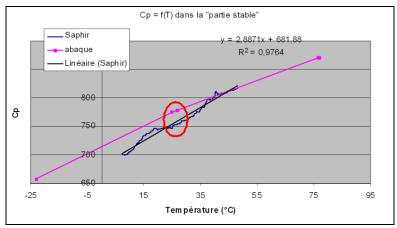
Figure 23 Capacité thermique du saphir
