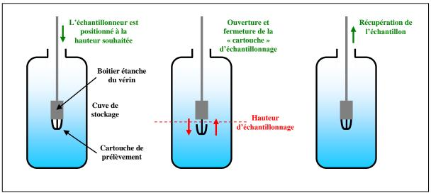
Figure 150 Fonctionnement de l'échantillonneur pneumatique
