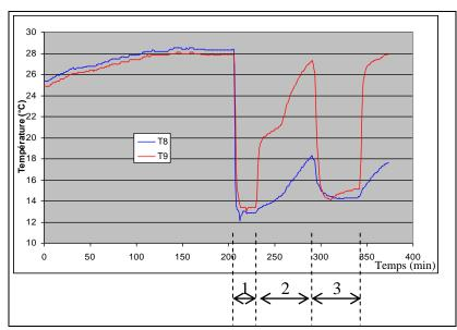
Figure 139 Mesures des températures d'entrée et de sortie du sorbet d'un ventiloconvecteur
