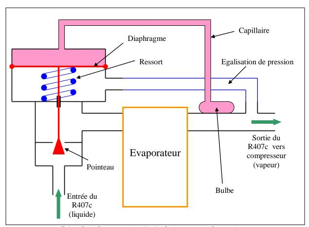
Détendeur thermostatique à régulation externe de pression
