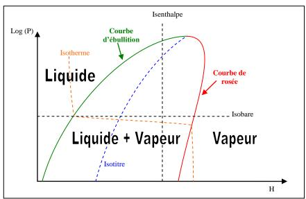
Figure 62 Diagramme enthalpique schématique du R407C
