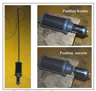
Figure 151 L'échantillonneur pneumatique
