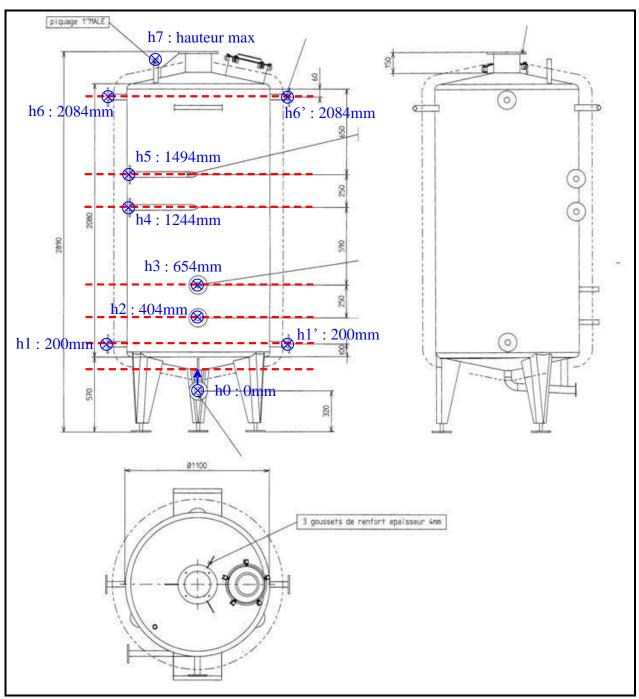
Figure 166 Hauteurs équivalentes de la cuve
