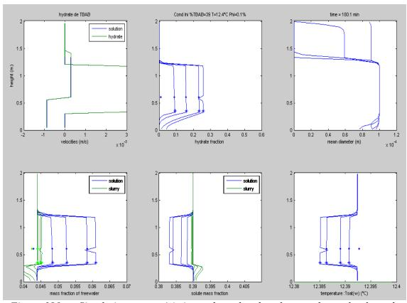
Figure 190 Simulation, caractéristiques du sorbet dans la cuve durant la phase de génération à 15 m³/h
