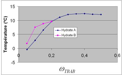
Figure 159 Diagramme expérimental d'équilibre des hydrates de TBAB (DARBOURET, 2005)
