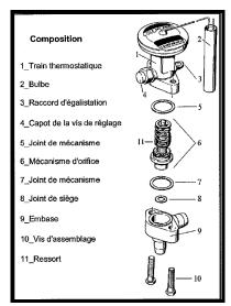
Figure 64 Détendeur ALCO TCLE
