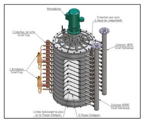
Figure 3 Générateur à surface brossée HeatCraft (COMPINGT, 2009)
