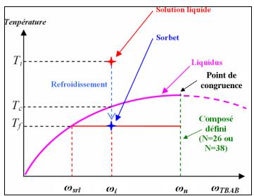
Figure 10 Diagramme de phase simplifié, méthode des moments
