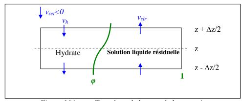
Figure 164 « Tranche » de la cuve de hauteur  $\Delta z$
