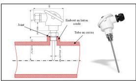
Figure 81 Sondes de température PT100 et leur raccordement physique
