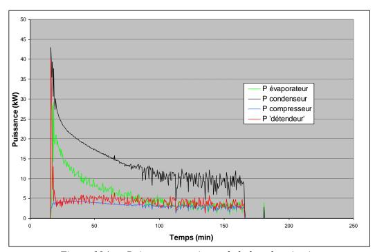
Figure 104 Puissances au niveau de la boucle primaire
