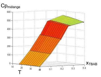
Figure 26 Valeur absolue de « Cp de mélange » en fonction de la température et de la fraction massique en TBAB
