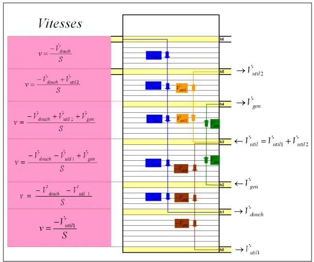
Figure 167 Vitesses du sorbet dans la cuve
