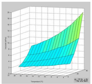
Figure 51 Viscosité des solutions en fonction de la température et de la fraction massique en TBAB, échantillons « Labo »
