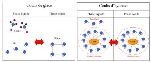
Figure 157 La transposition du modèle, \*notion d'hydrate fondu
