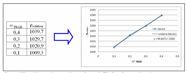
Figure 173 Masse volumique d'une solution de TBAB en fonction de sa fraction massique en TBAB (à proximité de la courbe de saturation)
