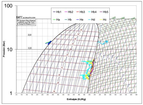
Diagramme enthalpique des capteurs d'HeatCraft
