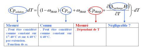
Les deux courbes «  $Cp_{solution}$  » et «  $(1-\omega_{TBAB})\cdot Cp_{eau}+\omega_{TBAB}\cdot Cp_{TBAB}$  » vont être tracées sur un même graphe (Figure 25). La courbe  $Cp_{solution}$  est issue des mesures de la partie précédente (Figure 22). La deuxième courbe est tracée en considérant un Cp de l'eau constant de 4180 J/kg/K (entre 17 et 40°C) et les deux CP « extrêmes » (17 et 40°C) du TBAB pur. C'est pourquoi deux droites sont figurées dans la Figure 25.
