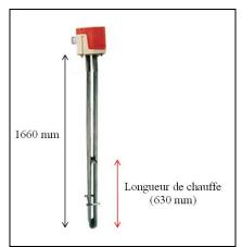
Figure 74 Thermoplongeur destiné à chauffer la cuve chaude
