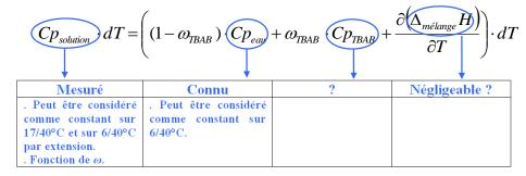
Il a donc été décidé de procéder à une mesure de la capacité thermique du TBAB pur afin de pouvoir comparer la courbe expérimentale obtenue  $Cp_{solution} = f(\omega_{TBAB})$  à la courbe théorique  $Cp_{solution} = (1 - \omega_{TBAB}) \cdot Cp_{eau} + \omega_{TBAB} \cdot Cp_{TBAB}$  dans le but de vérifier si les effets dus au mélange sont négligeables ou pas.
