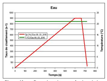
Figure 41 Paramètres internes du viscosimètre
