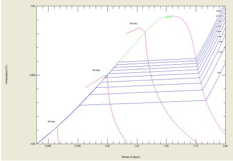
Figure 106 Diagramme T/S (Température / Entropie) du R407C
