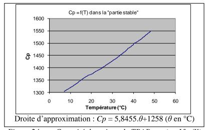
Figure 24 Capacité thermique du TBAB pur (en J/kg/K)
