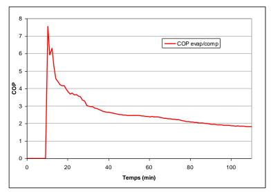
Figure 141 COP Puissance d'évaporation/Puissance de compression
