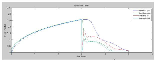
Figure 194 Simulation, fractions d'hydrates (débit de 15 m³/h en génération)
