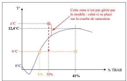
Figure 162 Refroidissement de la solution de TBAB dans le diagramme d'équilibre schématique
