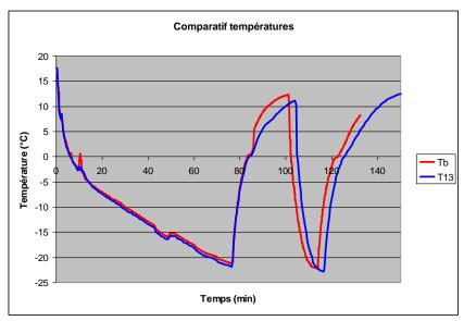
Comparatif des températures des capteurs 13 et b
