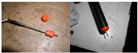
Figure 73 Montage des sondes de température de la cuve chaude
