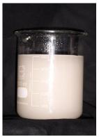
Figure 112 Aspect d'un sorbet d'hydrates de TBAB (DARBOURET, 2005)
