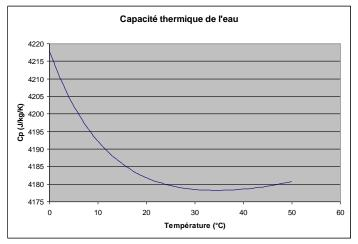
Figure 19 Capacités thermiques de l'eau pure
