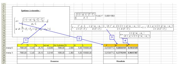
Tableau 39 Résolution du système d'équation pour déterminer  $\alpha$  et  $\lambda$
