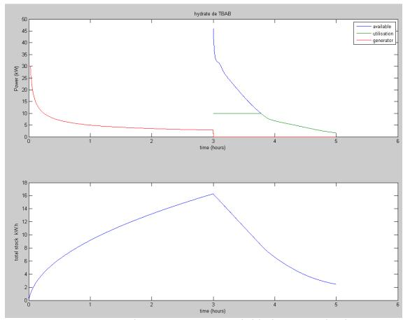
Figure 198 Simulation, puissance et stock d'hydrates avec douchage
