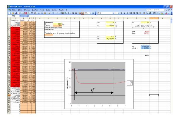
Sur la gauche de cette feuille Excel figurent les relevés de T (température dans le réacteur) et T0 (température du laboratoire) en fonction du temps. On voit sur le graphe que la température T est au départ égal à T0 car le réacteur n'a pas encore été rempli. La température amorce ensuite une descente lorsque le réacteur est rempli. Nous avons donc mesuré le temps de fusion tf depuis cet instant jusqu'à ce que le palier de température de fusion soit franchi.
