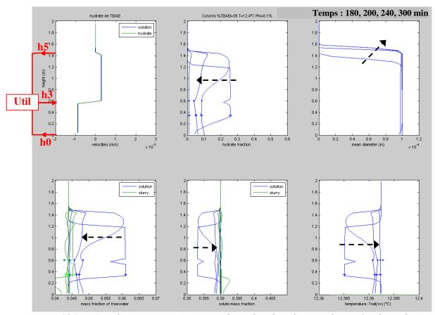
Figure 184 Simulation, caractéristiques du sorbet dans la cuve durant la phase de distribution
