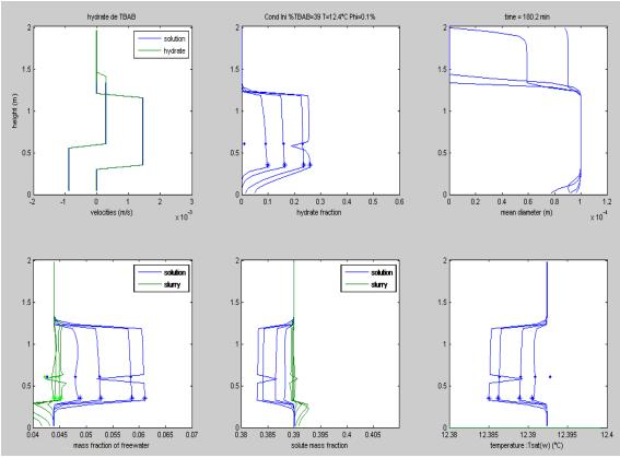
Figure 189 Simulation, caractéristiques du sorbet dans la cuve durant la phase de génération à 5 m³/h
