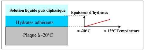
Figure 116 Caractéristiques du sorbet dans le cristalliseur
