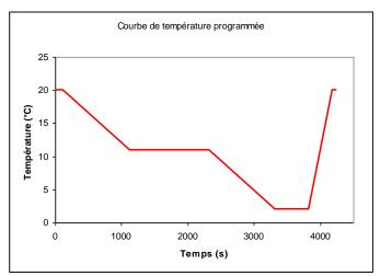
Figure 45 Courbe de température avec pallier imposée par le viscosimètre
