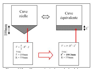
Figure 165 Hauteur équivalente du fond de cuve
