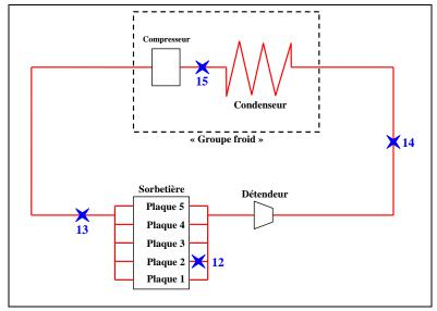
Figure 96 Localisation des capteurs sur la boucle primaire
