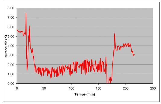
Figure 101 Surchauffe en sortie d'évaporateur
