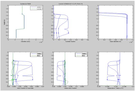
Figure 191 Simulation, caractéristiques du sorbet dans la cuve durant la phase de distribution (génération à 5 m³/h)
