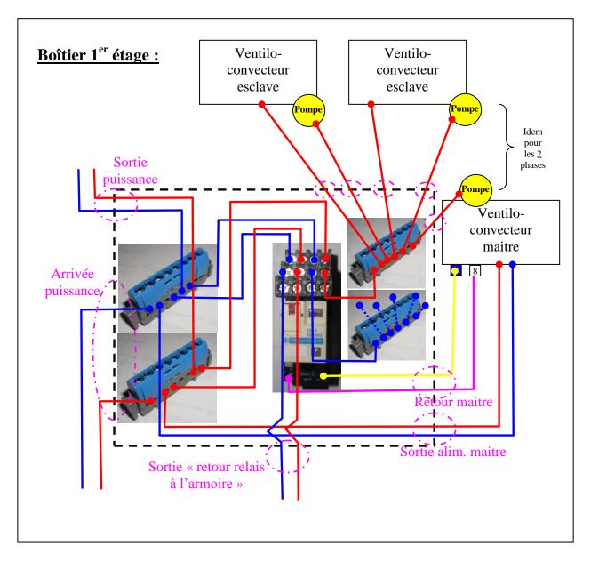
Remarque: Dans la pratique le fil schématisé ici en jaune et positionné sur une borne bleu du ventilo-convecteur est directement relié à la borne d'alimentation en puissance bleu du ventilo-convecteur. Ce fil jaune a donc été remplacé par un fil à l'intérieur du boîtier partant de l'arrivée puissance (bleu) jusqu'au relais (cela est vrai pour tout les boîtiers).
