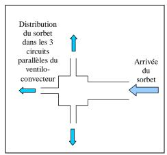
Figure 137 Géométrie schématique du distributeur des ventilo-convecteurs
