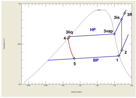
Figure 107 Cycle primaire considéré dans le diagramme T/S
