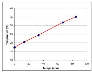
Figure 76 Montée en température de la cuve chaude
