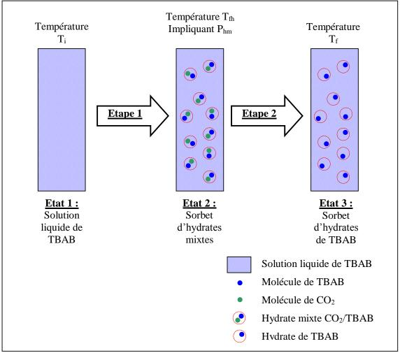
Figure 145 Principe de génération d'hydrates de TBAB par injection de CO<sub>2</sub>
