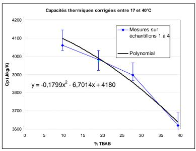
Figure 32 Capacités thermiques des solutions liquides de TBAB, courbe de tendance
