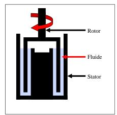
Figure 39 Schéma de la cellule du viscosimètre
