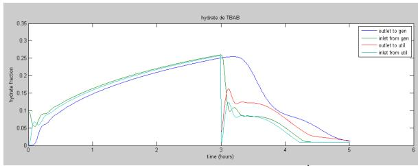
Figure 193 Simulation, fractions d'hydrates (débit de 5 m³/h en génération)
