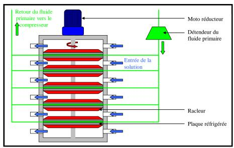
Figure 58 Principe de fonctionnement du générateur HeatCraft
