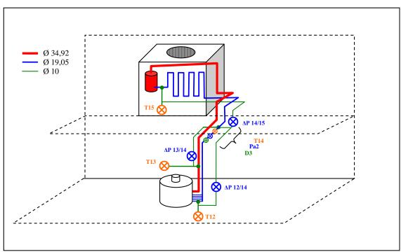
Figure 85 Schéma de la boucle primaire et repérage des capteurs
