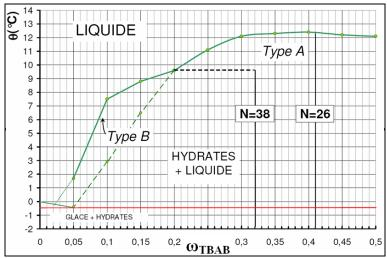
Figure 9 Diagramme d'équilibre des hydrates de TBAB (DARBOURET, 2005)
