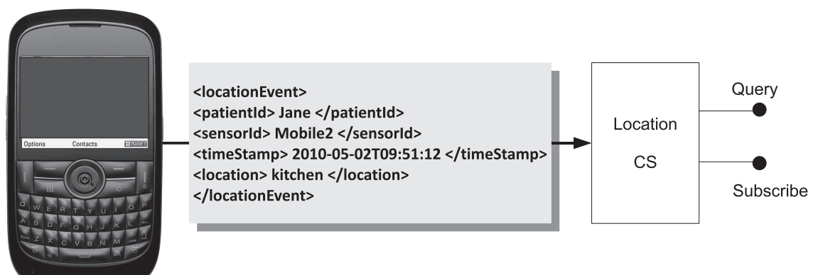
Figure 8.6 – Acquisition des événements capteurs et dispositifs
