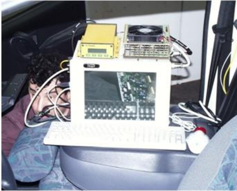
Figura 2.9: PC industrial embarcado en Rocinante
