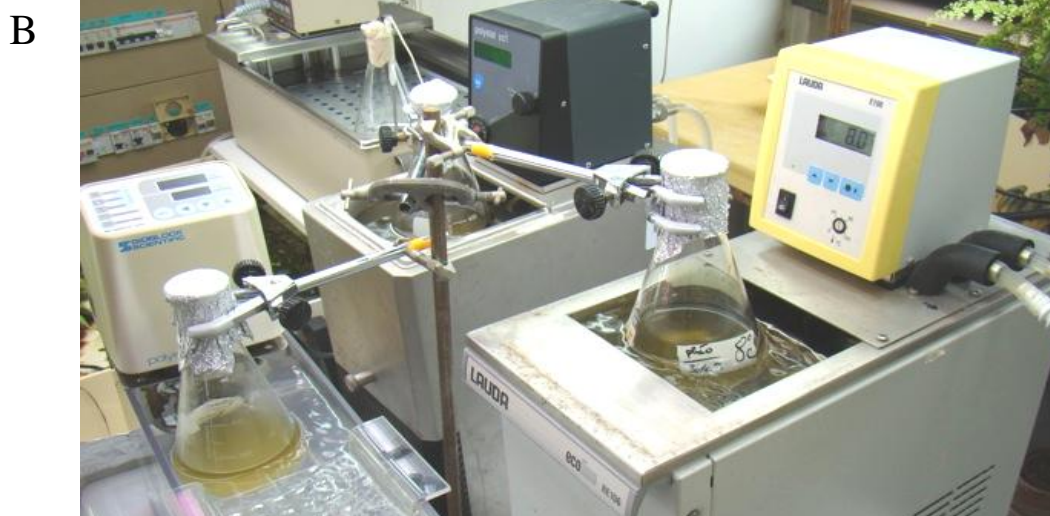
Figure 23 : Dispositif expérimental utilisé pour appliquer les stress thermiques aux trois diatomées Phaeodactylum tricornutum , Amphora coffeaeformis et Amphora acutiuscula .
