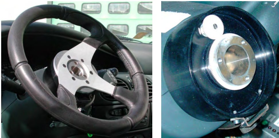
FIG. 6.4. : Dispositif de mesure de l'angle de braquage
