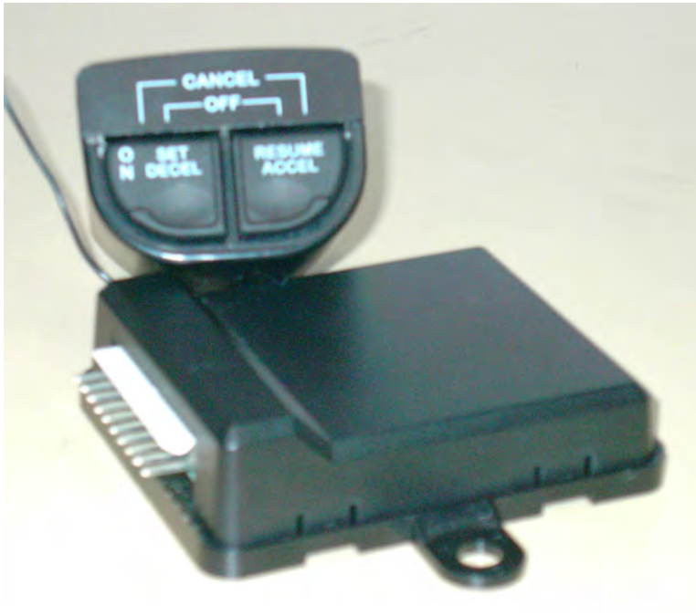
FIG. 4.1. : Télécommande & récepteur HF du véhicule NADINE
