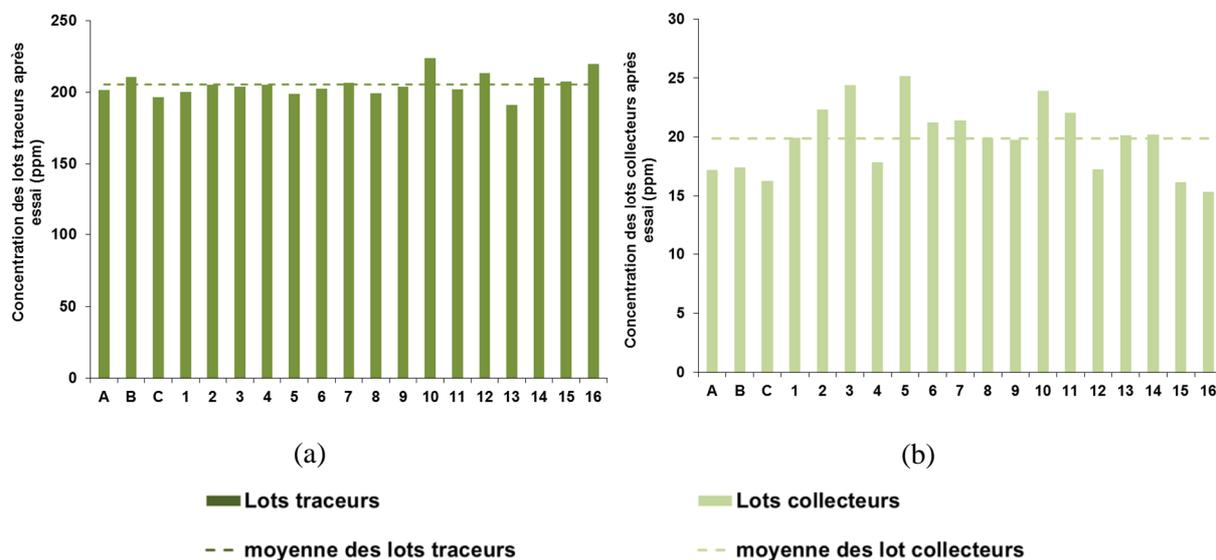
Figure 71 : Concentrations des lots traceurs (a) et collecteurs (b) après leur passage (ppm) dans l'élévateur pour les essais " Traceur + collecteur "
