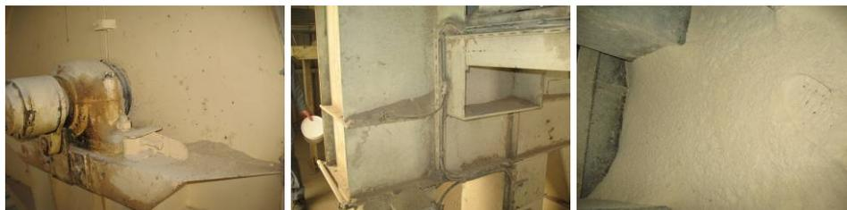
Figure 36 : Dépôts au niveau de la tête de l'élévateur. De gauche à droite, usines 1, 2 et 3
