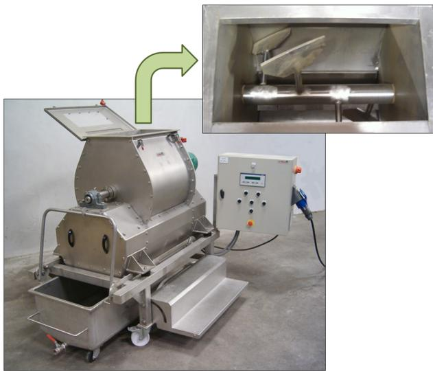
Figure 48 : Mélangeuse à pâles pilote
