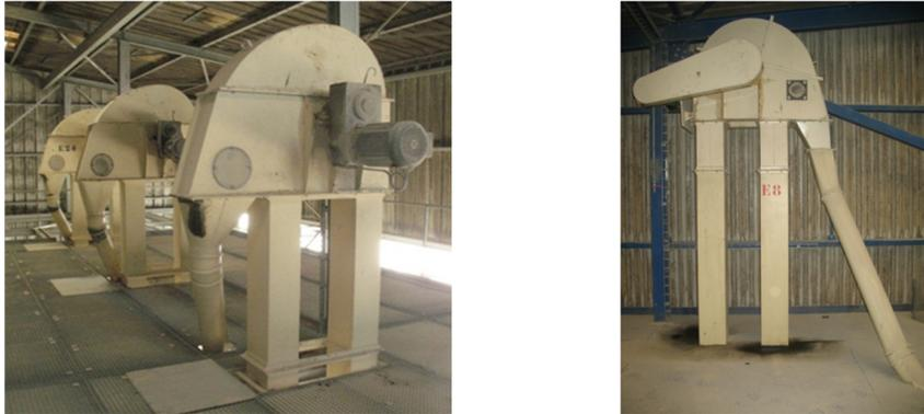
Figure 15 : Photographies de têtes d'élévateurs industriels
