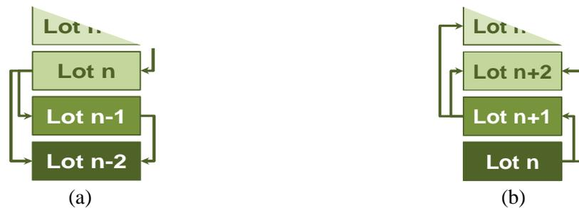
Figure 6 : Schéma des processus de contaminations croisées vers l'avant (a) et vers l'arrière (b)
