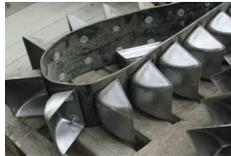
Figure 18 : Sangle et godets d'élévateur
