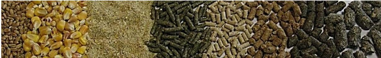
Figure 2 : Évolution de la forme des produits au cours de la fabrication d'un aliment pour animaux. De la matière première en grains (à gauche) aux granulés (à droite), en passant par le mélange de matières premières broyées
