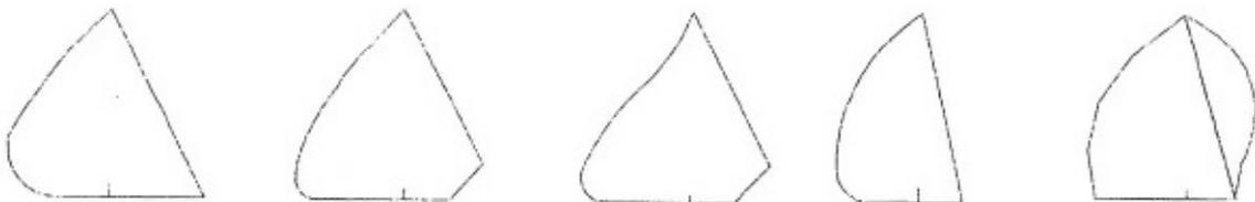
Figure 32 : Formes de godets expérimentées (Jaluski, 2008) de gauche à droite : forme polie, forme logarithmique, tulipe, type C (monobloc embouti), godet américain.
