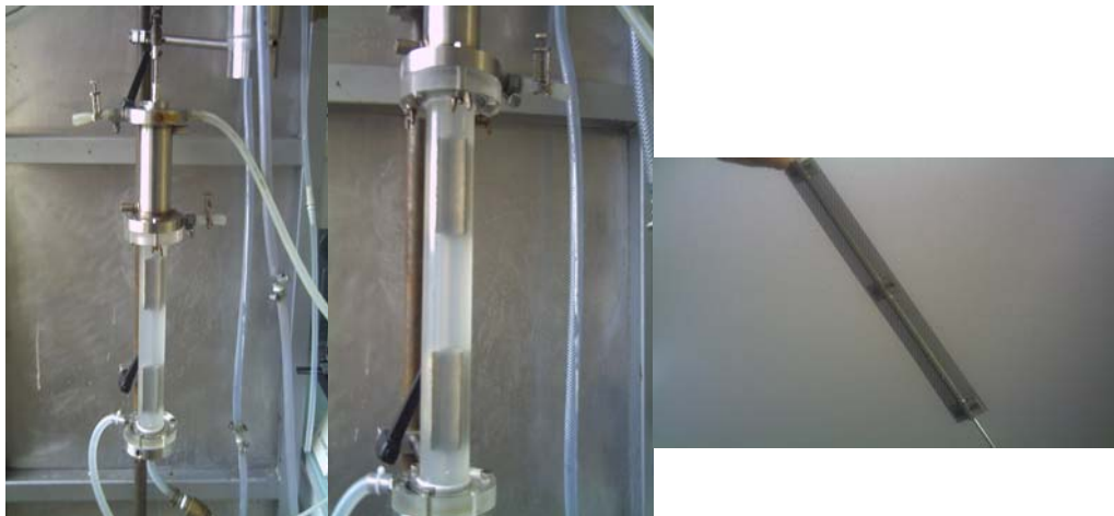
Figure II.12 : Photos de la colonne en plexiglas et du module d'agitation.
