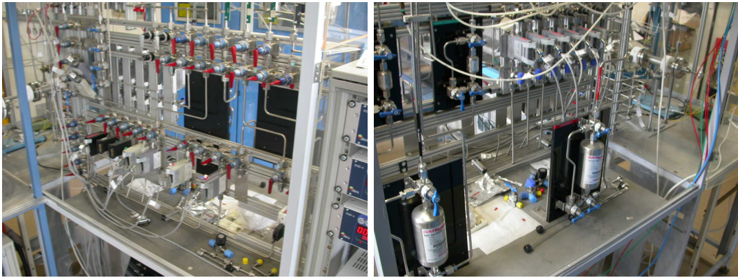
FIG. 2.12 – Vue du panneau des gaz (a) à l'avant et (b) à l'arrière.
