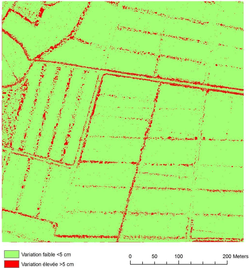
Figure 5.15 – Variations de l'altitude induite sur le MNT par un sous-échantillonnage de 75 % des points "sol" LiDAR, marais de Boucey.
