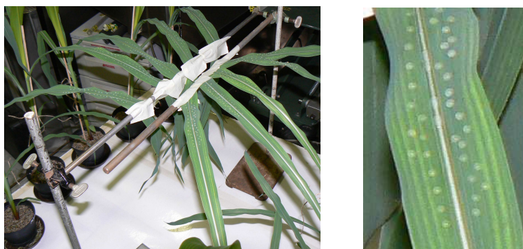
Figure II.6: Feuilles de maïs après l'application d'une solution de Mikado dopée à l'aide d'une micropipette automatique, V_{\text{gouttelettes}}=5 \mu\text{l} , C_{\text{sulcotrione}}=400 \text{ g/ha}
