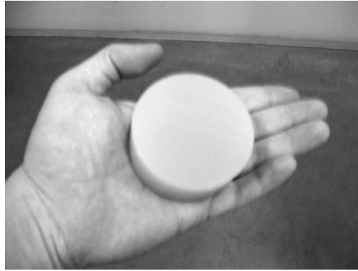
FIG. 4.1 – Photo d'un cylindre de gel d'agar-agar.
