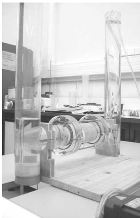
FIG. 4.7 – Vue de la cellule d'électro-osmose.
