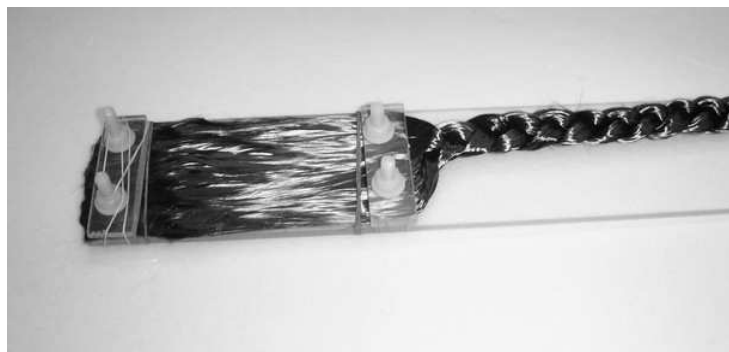
FIG. 4.12 – Vue d'une électrode en fibre de carbone.
