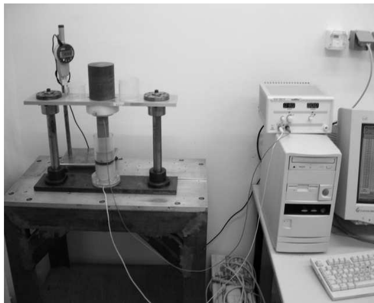
FIG. 6.3 – Photo du dispositif expérimental de consolidation.
