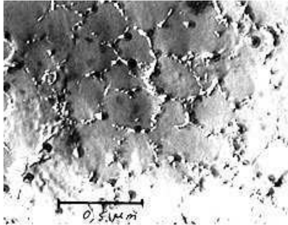
FIG. 4.2 – Observation au M.E.T. de la structure interne du gel d'agar-agar ( w_e = 2016\% ) [Mrani 1993].
