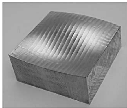
Pièce usinée avec un angle d'inclinaison constant de 9^\circ Hauteur de crête : 115 \mu\text{m}
