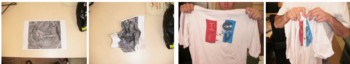
FIG. 4.24 – Déformations faisant échouer l'approche proposée. (a) Une feuille de papier froissée. (b) Un Tshirt présentant de multiples pliures.
