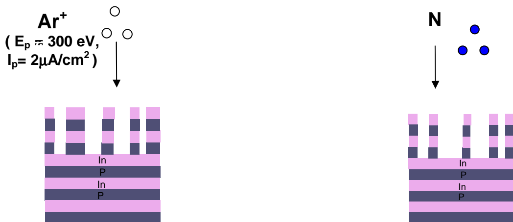
Figure 4.27 : Schématisation de processus de bombardement et de nitruration de l'InP poreux.
