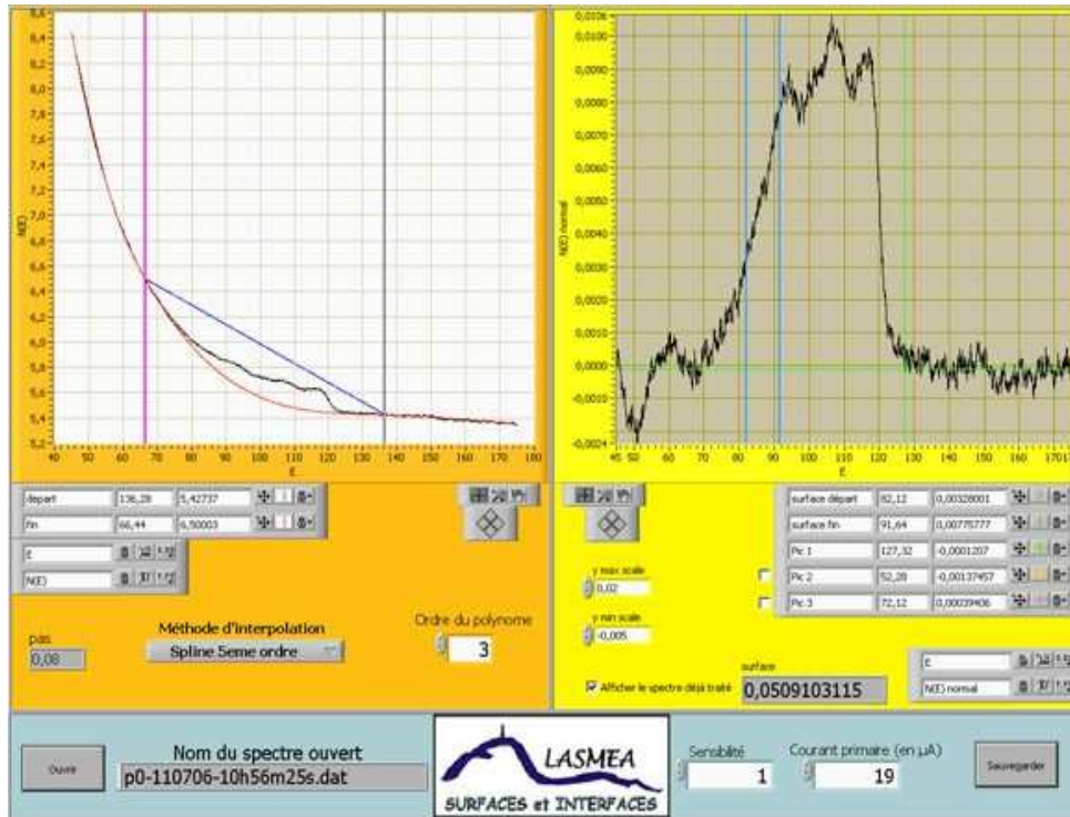
Figure 1.27 : Fenêtre de traitement des spectres, exemple d'un traitement d'un spectre de phosphore après nitruration
