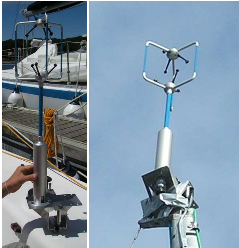
Figure 3.18 – WindMaster et son support en Inox en tête de mât du J80
