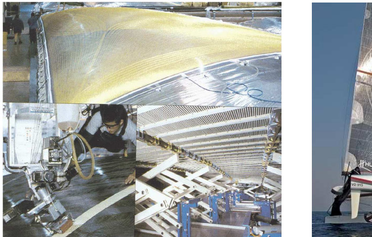
Figure 1.27 – Fabrication d'une voile 3DL (image issue du site www.northsail.com ). Exemple d'orientation des fibres sur les voiles du catamaran Alinghi 5
