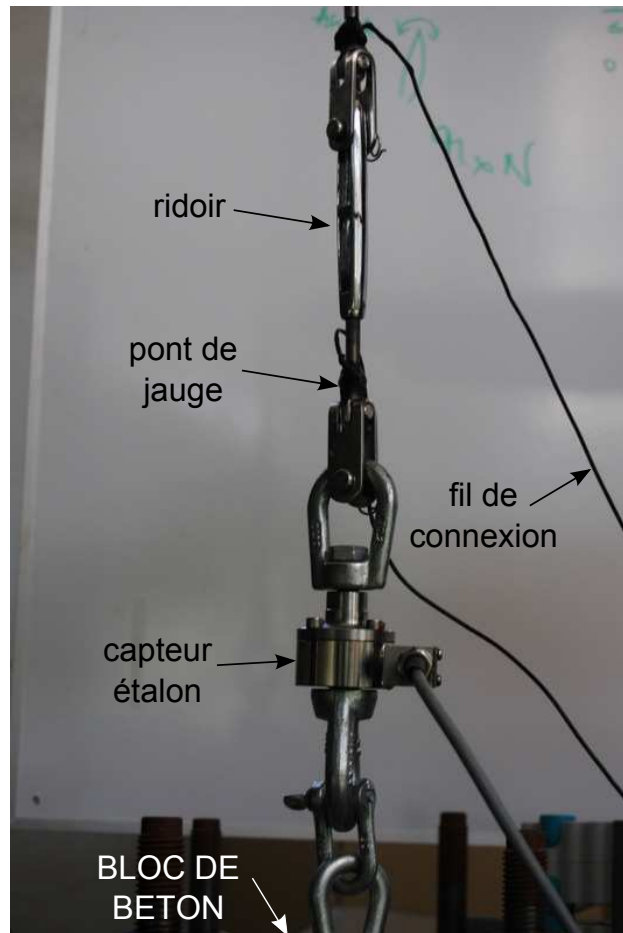
Figure 3.4 – Capteur étalon monté en série avec les ridoirs entre un bloc de béton au sol et la chaîne de levage
