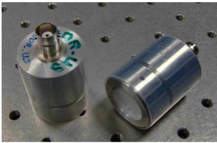
(a) Transducteurs piézoélectriques à couplage par air ULTRAN<sup>®</sup> à faisceau à convergence circulaire, résonnants à 500 kHz.
