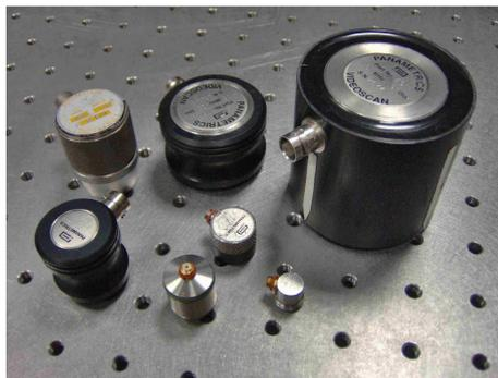
(a) Transducteurs piézoélectriques pour le CND allant de 100 kHz à 5 MHz
