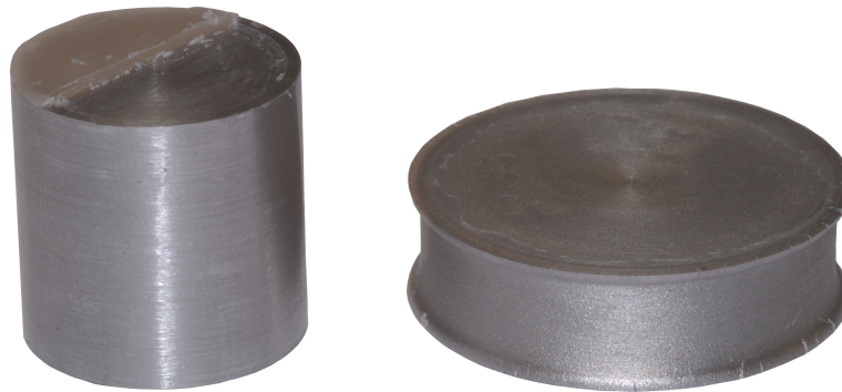
Fig. 3.1.9: Photographies des échantillons de type Rastegaev avant et après compression
