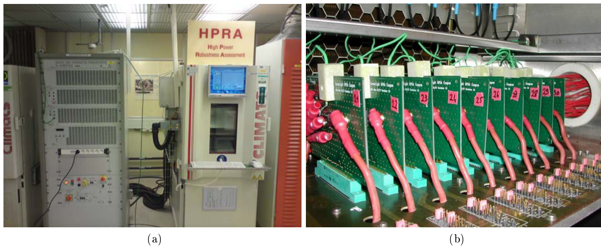
FIGURE 3.20 – a) Vue d'ensemble du banc de vieillissement, b) disposition des cartes de circuit imprimé.
