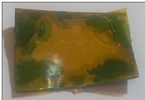
Figure 44 : Photographie d'une l'électrode de Nickel-LiFePO 4 (côté collecteur de courant) ayant séjourné un mois dans une solution d'eau + LiNO 3 (5M) à 55°C.
