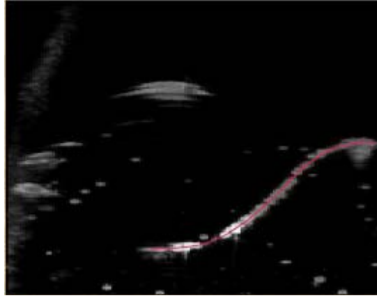
Fig. I-3 Image 3D d'une aiguille insérée dans le tissu artificiel détectée par ultrason
