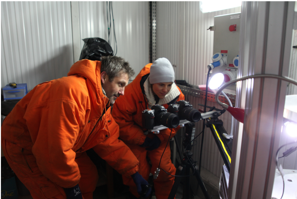
FIGURE 2.25 – Dispositif pour la prise de vue en stéréocorrélation.
