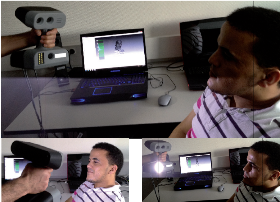
FIGURE 2.6 – Un aperçu des différentes étapes de la procédure d’acquisition avec le scanner 3D à lumière blanche. Les images de la deuxième ligne montrent la projection de la lumière blanche sur la surface faciale 3D.
