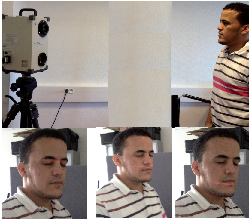
FIGURE 2.5 – Un aperçu des différentes étapes de la procédure d'acquisition avec le scanner 3D laser. Les images de la deuxième ligne montrent le balayage du faisceau laser sur la surface faciale 3D.
