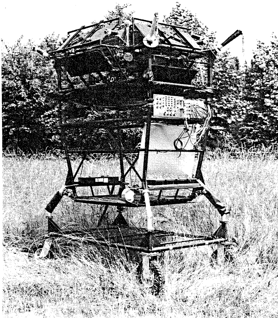
Fig. 4 Expérience AGATHE, comportant des plateaux de chambre à étincelles de 1 \text{ m}^2 de surface (Cliché SEP/CEA)
