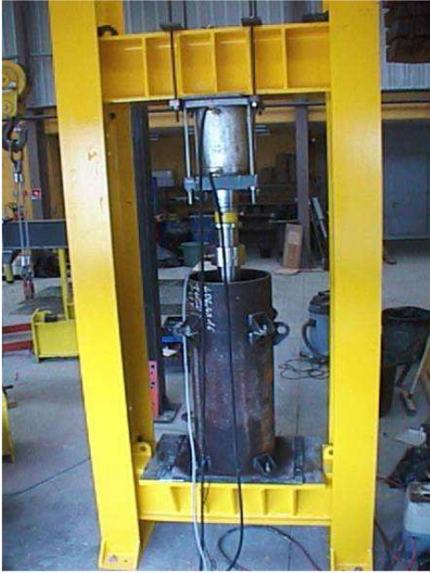
Figure 3-23 : confection d'une éprouvette sous compactage quasi statique (cf. Chaigneau, 2001).
