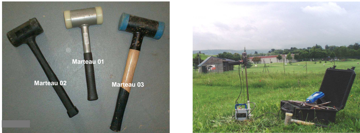
Figure 2-18 Validation de l'appareil : (a) types de marteaux employés et (b) réalisation du sondage in-situ.
