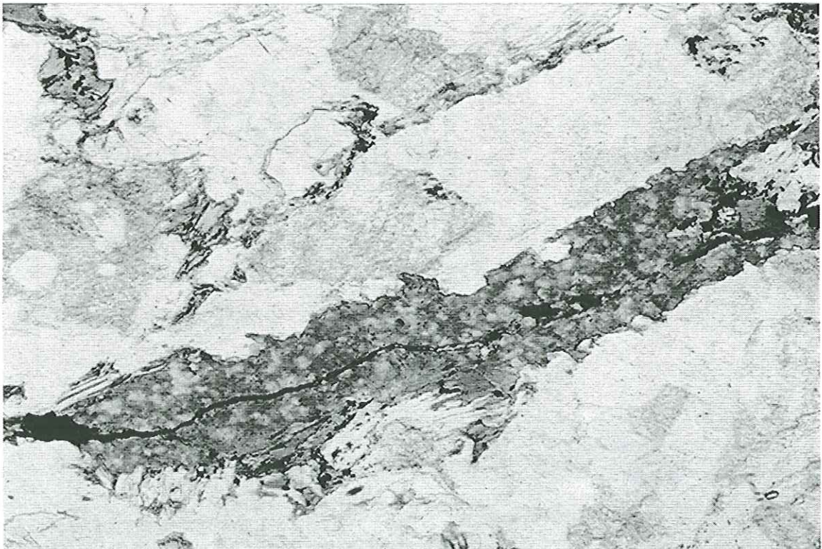
ANNEXE V-3. - Mylonite à séricite (LM M28, grossissement 4). Le boudinage du Quartz est bien marqué. La déformation est accommodée par les lits de micas blancs.
