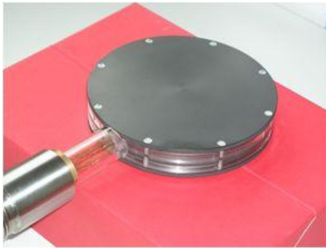
figure III.2_calorimètre placé dans l'enceinte à vide (à gauche) ; calorimètre positionné dans le fantôme graphite (à droite).
