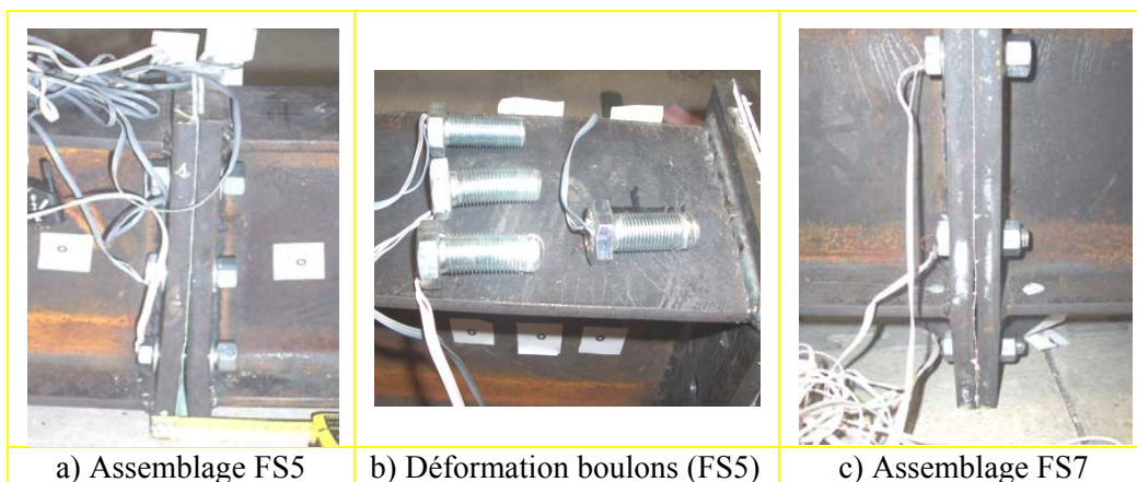
Figure II-30 : Modes de ruines des différents assemblages poutre-poutre
