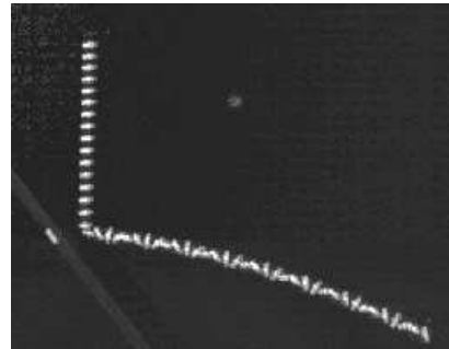
FIGURE 2.10 – Particule peinte lâchée sur une pale inclinée de 50^\circ .
