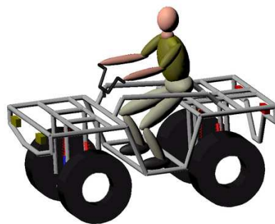
FIG. 1.36 – Modélisation du pilote sous Adams.
