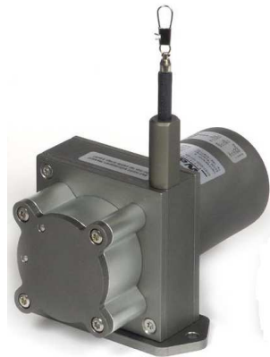
FIG. 1.24 – Potentiomètre linéaire filaire utilisé pour la mesure de l'angle de braquage.
