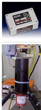
(a) Gyromètre DSP3000 et plate-forme d'évaluation.
