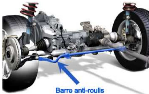
FIG. 1.11 – Montage d'une barre anti-roulis sur l'essieu avant d'une automobile - www.auto-innovations.com
