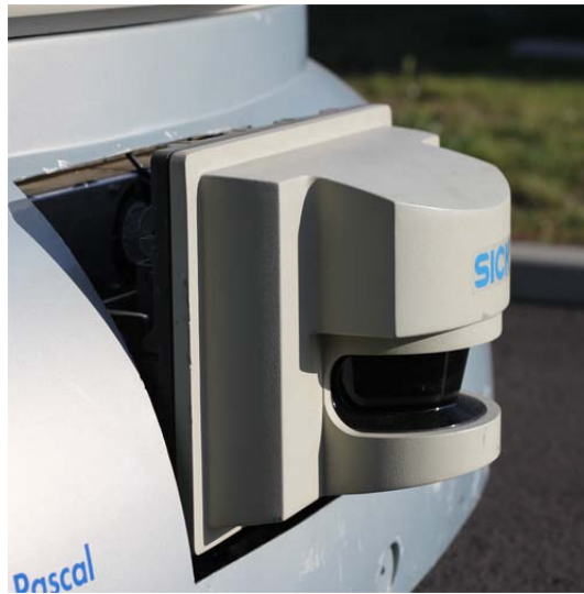
FIGURE 6.4 – Télémètre laser utilisé pour la détection du véhicule de tête.
