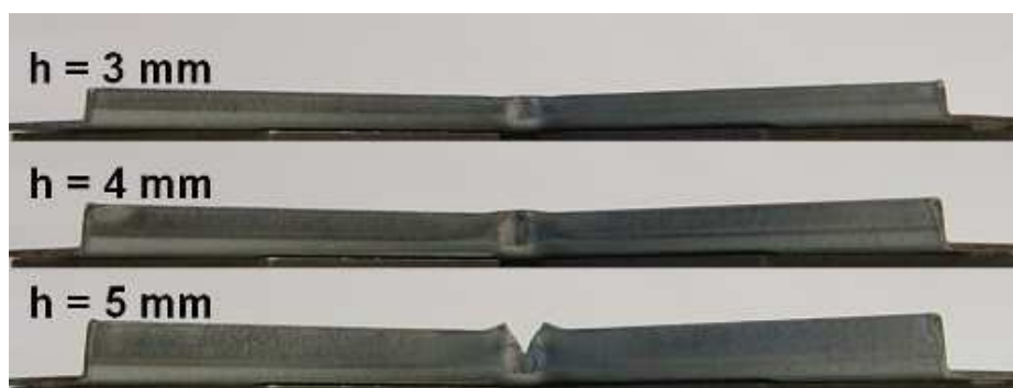
FIG. 3.33 – Intégrité du bord tombé sur les éprouvettes en DC04
