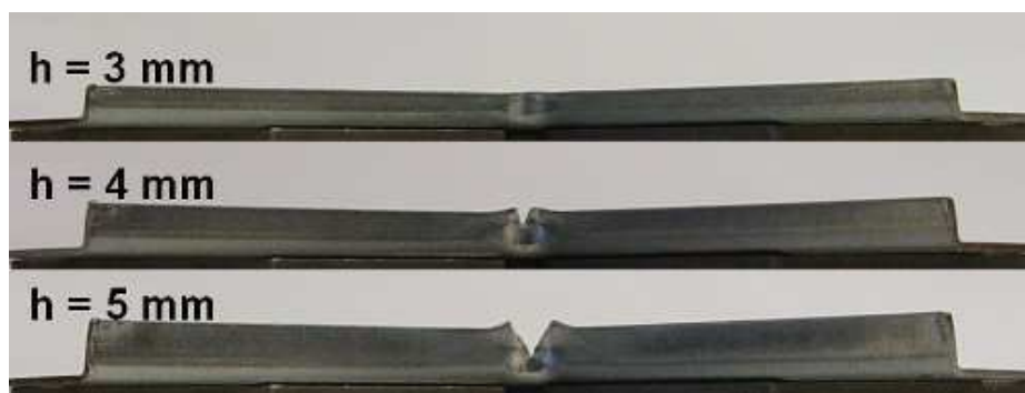
FIG. 3.34 – Intégrité du bord tombé sur les éprouvettes en E220BH
