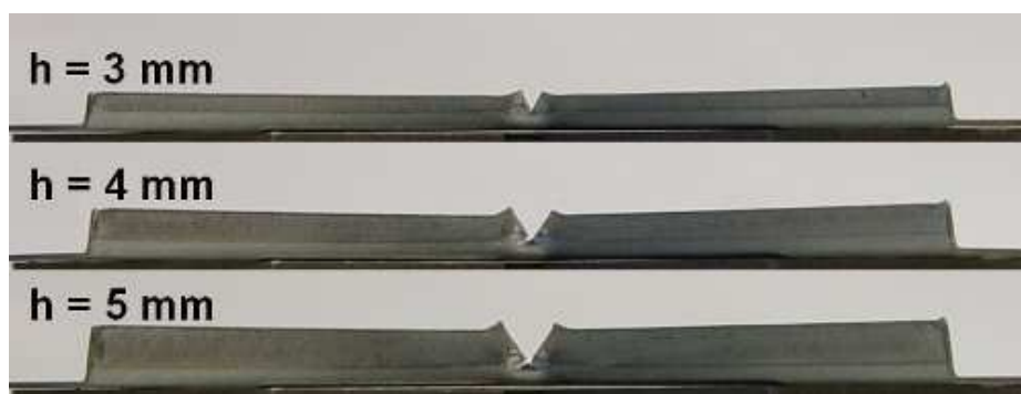
FIG. 3.31 – Intégrité du bord tombé sur les éprouvettes en DP500 à hauteur de bord constante
