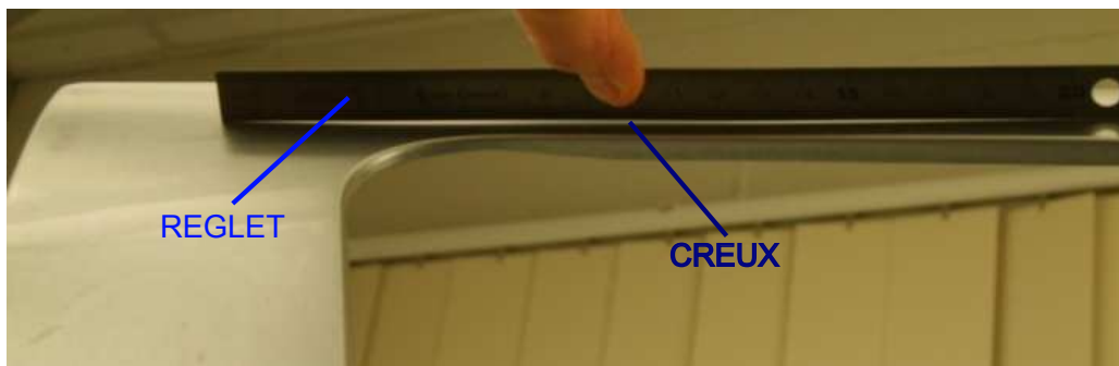
FIG. 5.2 – Visualisation du défaut d'aspect sur le coin de cadre A51 avec un réglet
