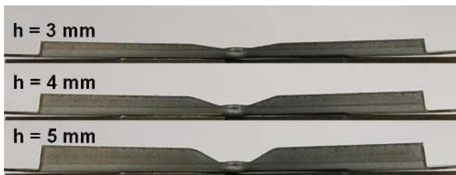
FIG. 3.32 – Intégrité du bord tombé sur les éprouvettes en DP500 à hauteur de bord réduite
