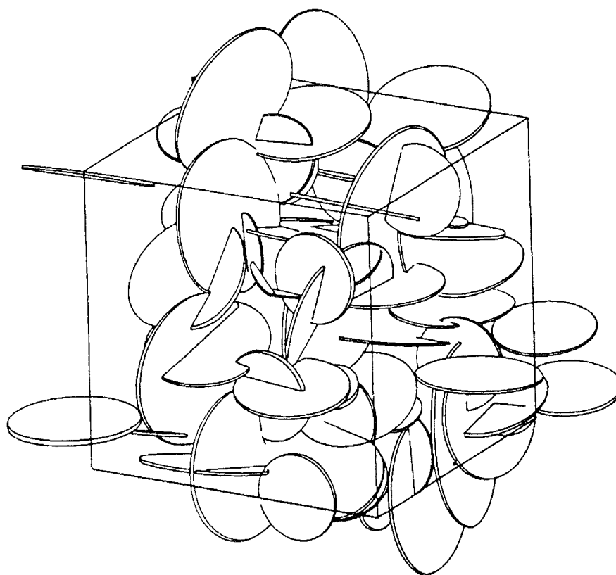
Fig. 9.- Génération stochastique d'un réseau tridimensionnel de fractures représentées par des disques (d'après Billaux [1990]).
