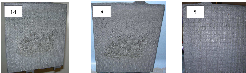
Figure 8 : photos d'électrodes négatives cellule 14 témoin Q_c=120\% (40 cycles), cellule 8 ( f=3,2 Hz ; r=0,75 ; Q_c=120\% ) (40 cycles), cellule 5 ( f=3,2 Hz ; r=0,25 ; Q_c=120\% ) (80 cycles).
