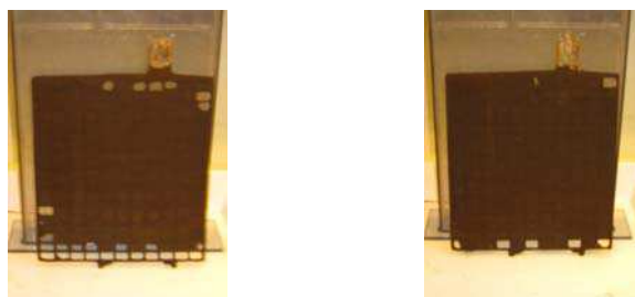
Figure 20 : Photos des électrodes positives après 60 cycles, gauche : cellule C' (courant constant), droite : cellule P'1 (courant pulsé).
