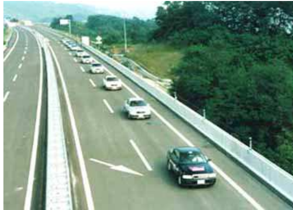
FIG. 4-3 – Application de la conduite en peloton
