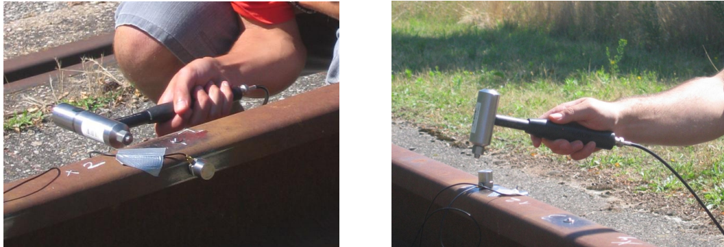
FIGURE 5.2: Disposition du marteau de choc par rapport à l'accéléromètre. Gauche : vibrations verticales. Droite : vibrations latérales
