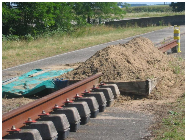
FIGURE 5.1: Le rail expérimental du LIER. Extrémité ensablée pour éviter les réflexions en bout de rail.
