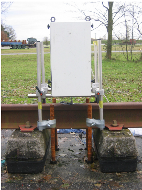
FIGURE 5.12: Gauche : le pot vibrant dans son coffrage isolant, positionné pour une excitation verticale du rail. Droite : atténuation acoustique à 1 m du caisson par tiers d'octave.
