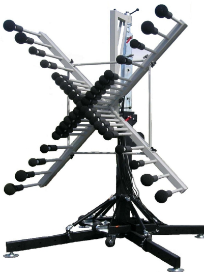
FIGURE 2.8: Antenne en croix utilisée par le LTE pour la caractérisation acoustique des tramways
