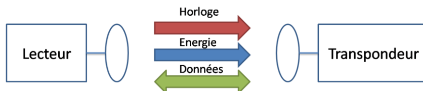
Figure 2 – La transmission d'informations et d'énergie dans un système sans contact
