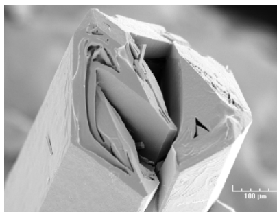
Figure 4- 14: Photographie SEM (x200) montrant un cristal d'AO avec des instabilités de surface et probablement des inclusions liquides.
