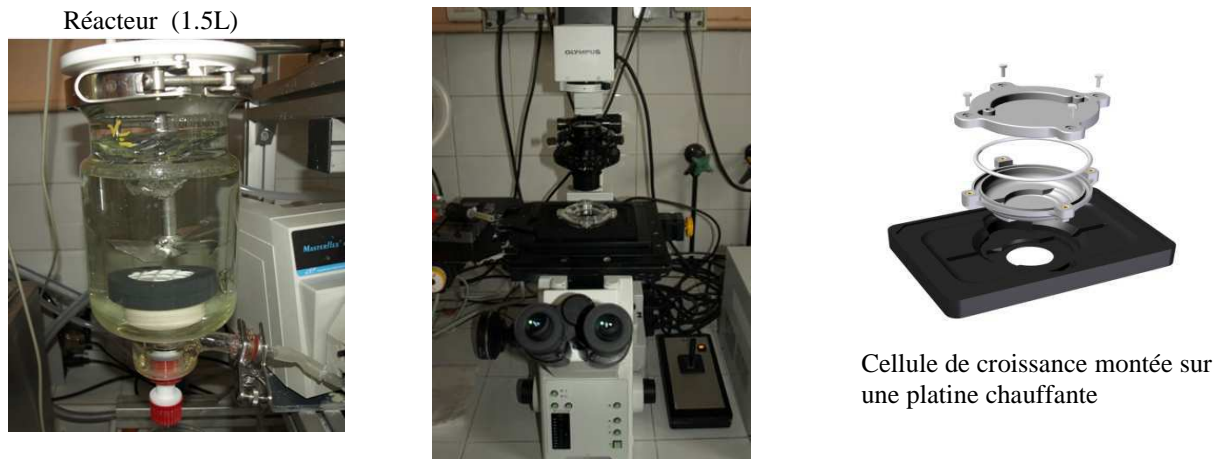
Figure 4- 20 : Dispositif de suivi de la croissance cristalline en cellule par microscopie optique
