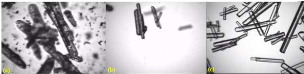
Figure 4- 53: Images acquises in situ lors de cristallisations par refroidissement à -30^\circ\text{C}/\text{h} en présence de : (a) 0.0019 \text{ mol/L} de \text{NiCl}_2 , (b) 0.0019 \text{ mol/L} de \text{NH}_4\text{SO}_4 et (c) solution d'AO pure.
