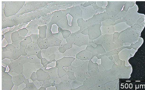
Figure 4.130 Microstructures obtenues pour les différents essais de torsion effectués sur l'alliage industriel Fe-8%Al
