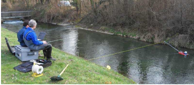
FIGURE 6.2.1: Mesure de débit dans le contre-canal par profileur Doppler (Le Coz et al. , 2008)
