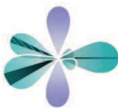
Figure I.4 : Orbitales atomiques du carbone dans le graphène. En vert sont dessinées les trois orbitales atomiques dans le plan responsables des liaisons covalentes avec les atomes voisins. En violet est dessinée l'orbitale p_z responsable de la conduction électrique.
