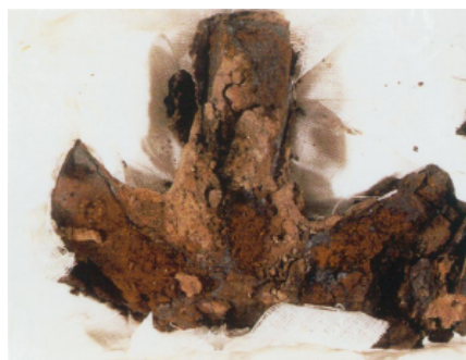
(c) Enclume fortement corrodée avec couche fracturée enlevée révélant la présence d'akaganéite de couleur orange en contact avec le métal, figure extraite de [134]
