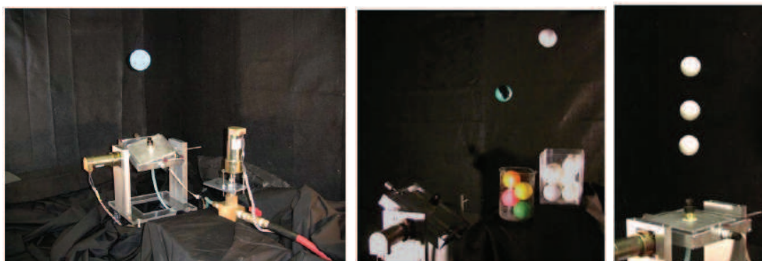
FIGURE 2.13 – Le système développé par Becker et al. [6] permet de positionner des objets dans l'espace, grâce à un flux d'air.
